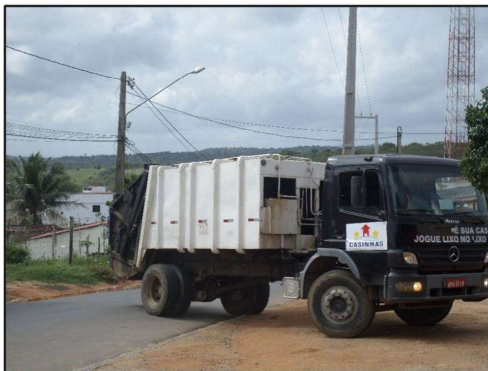
Figura 39: Caminhão compactador utilizado na coleta dos RSU do município de Casinhas - PE. Fonte: IDEST, 2014.
